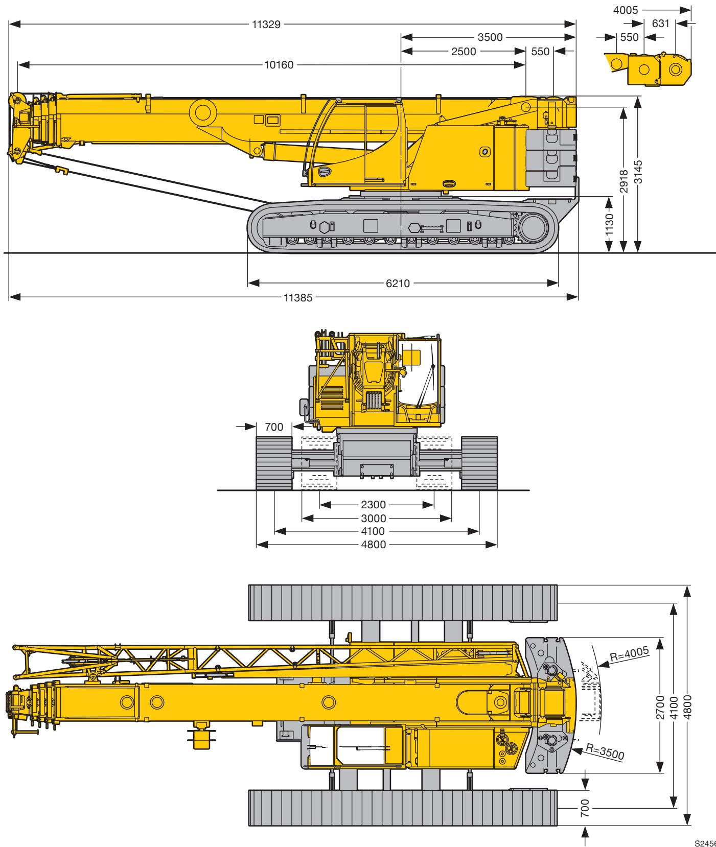
**Krane Daten****Crane data****Dates de la grue · Dati gru****Características · Технические характеристики крана**
