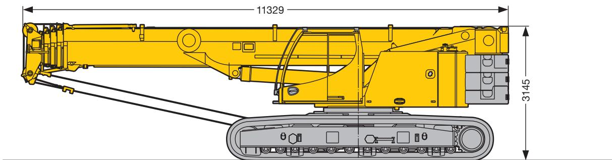
Ohne Drehbühnenballast und ohne Zentralballast · Without slewing platform counterweight and without centre counterweight · Sans contrepoids de la partie tournante et sans contrepoids central
