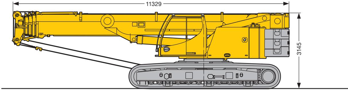
Mit Drehbühnenballast ohne Zentralballast · With slewing platform counterweight and without centre counterweight · Avec contrepoids de la partie tournante sans contrepoids central
